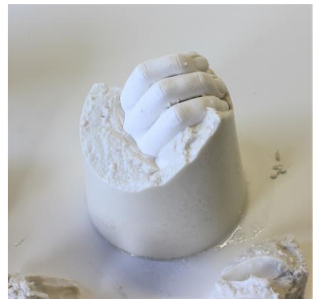
Fig 4.: Het Acrylhars afgietsel wordt uit de mal gehaald
